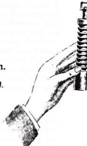
**Messinstrument mit akustischem Signal für Flüssigkeit-Oberflächen.**
