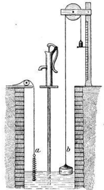
Fig. 6. Grundwassermessung. Schematischer Durchschnitt durch einen Grundwasserbrunnen. Bei a Messung mit PETTENKOFER'S Schälchenapparat; bei b Schwimmer mit oben abzulendem Zeiger.
