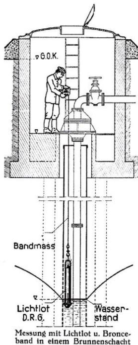
Lichtlote und Brunnenmesser sind die einfachsten Instrumente zur genauen Beobachtung des Grundwasserstandes und zur Messung der Tiefe des Wasserspiegels bei Brunnen, Behältern usw.
