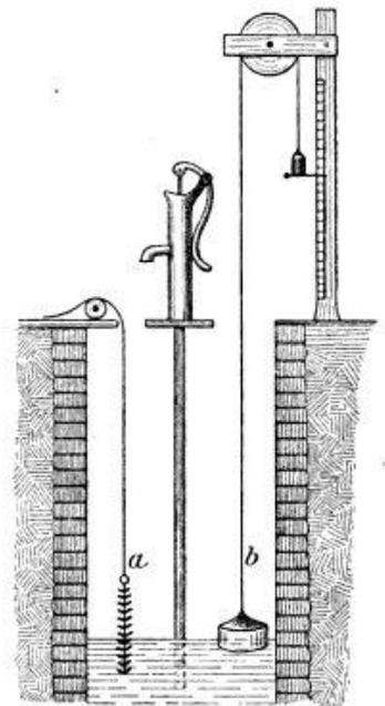
Fig. 6. Grundwassermessung. Schematischer Durchschnitt durch einen Grundwasserbrunnen. Bei a Messung mit PETTENKOPFER'S Schälchenapparat; bei b Schwimmer mit oben abzulendem Zeiger.
