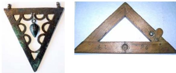
*ANGLE = Inclinometers*
